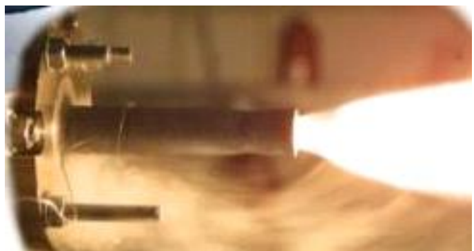
Laser-induzierte Zündung (H2/O2)
