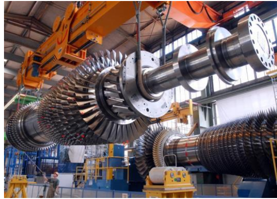
Kraftwerks- Gasturbine (bis > 300 MW) Siemens SGT5, Kraftwerk Irsching (D)
