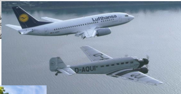
Ju52-Oldtimer um 2000 in Formation mit Lufthansa Boeing 737-500 Länge 31 m, 140 Passagiere Geschwindigkeit 900 km/h Reichweite 5200 km, Startgewicht 60 t
