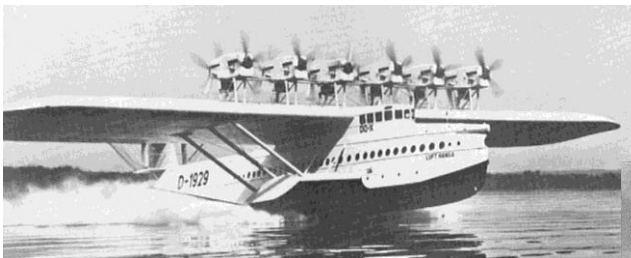
Dornier DoX, 1929, Flugboot für Transatlantikverkehr Länge 40 m, 70 Passagiere, Geschwindigkeit 200 km/h
